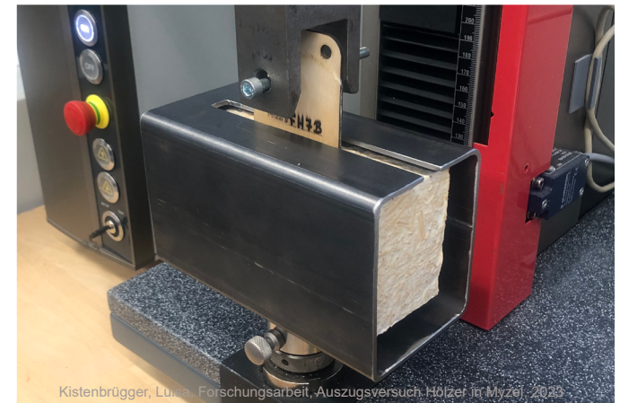
Kistenbrügger, Luisa, Forschungsarbeit, Auszugsversuch Hölzer in Myzel, 2023
