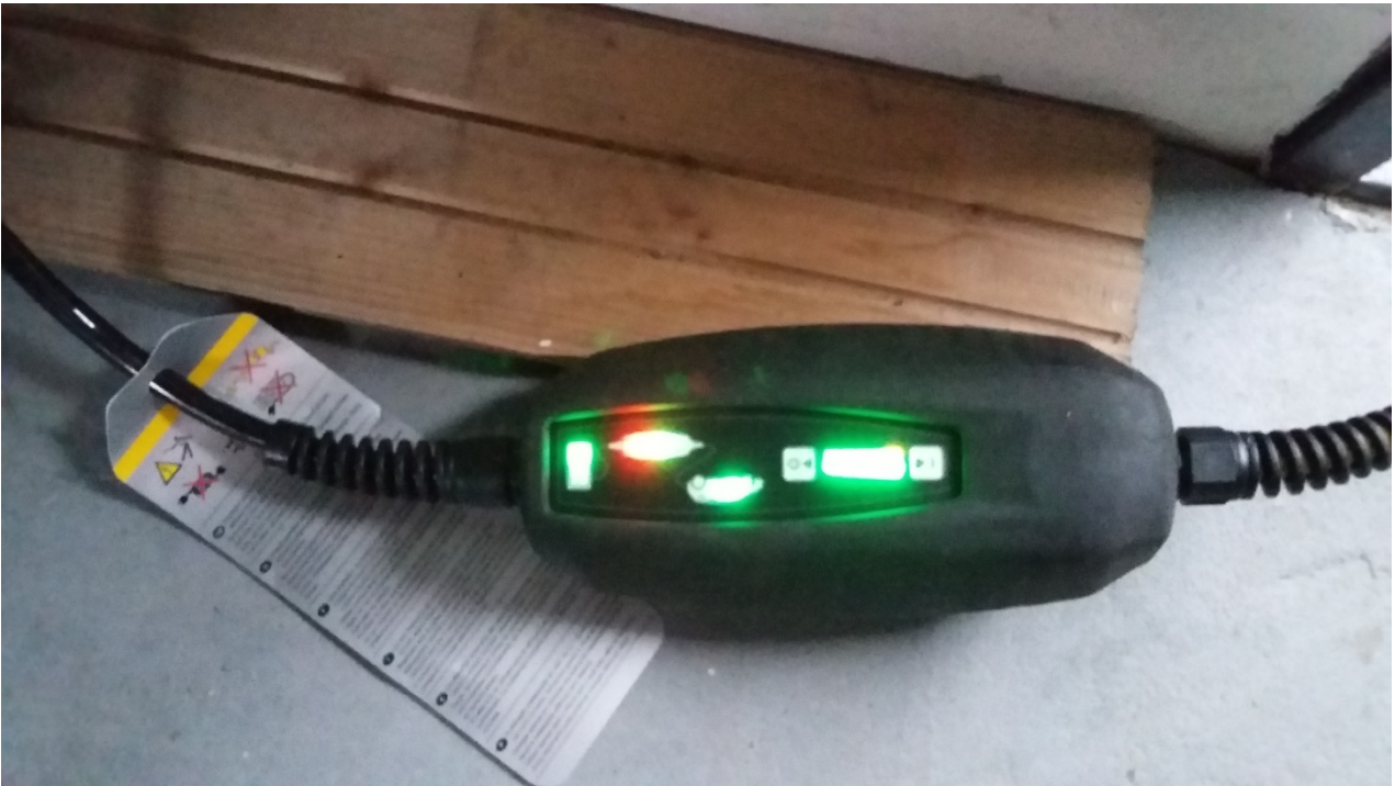
Abbildung 15: Schuko-Ladekabel mit „Steuergerät“ des Projekt-Autos
