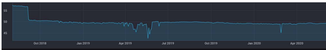
Abbildung 28 Temperatur im Zirkulationsrücklauf der Ultrafiltrationsanlage vom 3.8.2018 bis 3.06.2020 [12]
